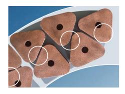
Die Prismenform der SINTRERFLEX Scheibenbremsbeläge garantiert eine maximale Abdeckung der Bremsscheiben, egal ob es sich um Radbremsscheiben oder Wellenbremsscheiben handelt. Auch bei starker Einfederung des Drehgestells werden die zulässigen Belagüberstände eingehalten. Dadurch werden Partikeleintragungen und Verschleiß durch Kantenbruch
