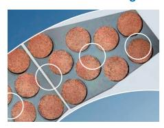
Herkömmliche Scheibenbremsbeläge mit zylinderförmigen Sinterblöcken neigen bei in Laufrädern integrierten Bremsscheiben zu Kantenbruch und höherem Verschleiß an Scheibe und Belag. Der Grund dafür ist die relativ geringe Abdeckung der ebenfalls runden und großen Bohrungen der Scheibenverschraubung.
