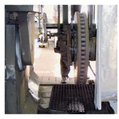
Die auf modernsten Prüfständen in ausgiebigen Dauertests ermittelten Daten von Reibwerten und Temperaturverhalten prädestinieren SINTERFLEX als Belag für den anspruchsvollen Einsatz im Hochlast- und Hochgeschwindigkeitsbereich.
